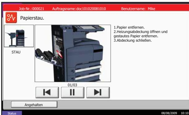
Bei einem Papierstau wird *Papierstau* auf der Berührungs-Anzeige angezeigt und das Gerät wird angehalten. Befolgen Sie die nachstehenden Anweisungen, um den Papierstau zu beseitigen.
